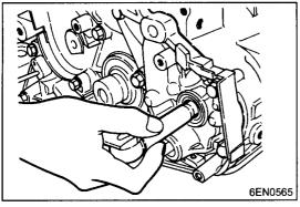
(2) Loosen the flange bolt.
