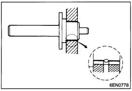
**▶**D**◀**OIL PUMP OIL SEAL INSTALLATION
