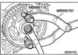
**◆C▶** INJECTION PUMP SPROCKET NUT LOOSENING
