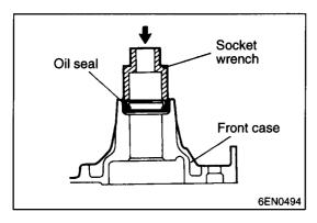
►E COUNTERBALANCE SHAFT OIL SEAL INSTALLATION
